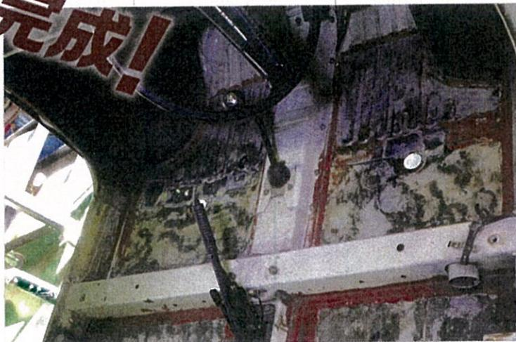
PPSシートは硬化後に透明になるので、写真で見ると穴が開いたままに見えるが、しっかりと穴部分は埋まった。これでフロアは完了。
