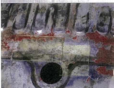
運転席側は穴が開いてしまった箇所は少ないが、腐食が進行して表面が凸凹して今にも穴が開きそう。この部分もPPSシートで補強する。
